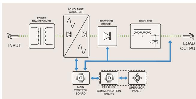
Le processus de rectification se fait avec 3 phase Pont de diodes. Puisque les thyristors de réglage de tension sont commutés aux passages par zéro de la tension alternative, il ne génère pas de distorsion harmonique dans la tension du réseau. Filtres de sortie maintiennent la tension continue stable et à faible valeur d'ondulation.
